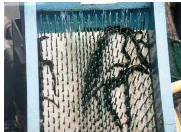
Espacements variables (ex : 2 densités de brosses différentes) pour permettre à des individus de tailles différentes de franchir
