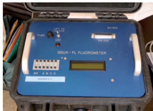
Fig 7.3 - Exemple de fluorimètre portatif (et sa console) utilisé pour le jaugeage par dilution (GGUN-FL30 - Albillia).
