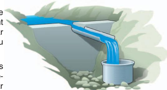
Fig. 3.1 - Exemple de dispositif de guidage du jet.
