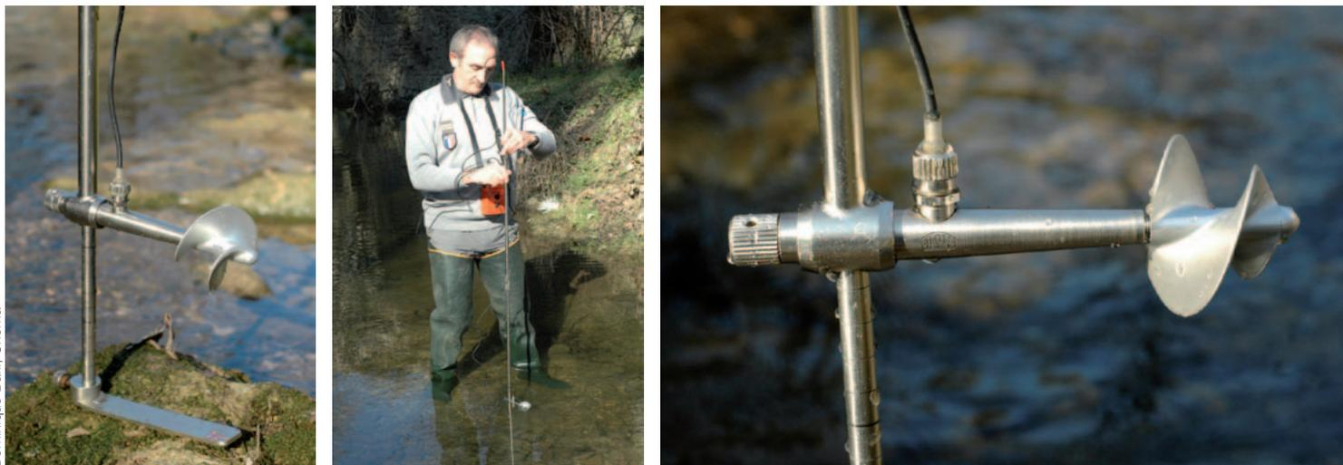
Fig. 4.2 - Exemple de montage d'un courantomètre mécanique (moulinet).
