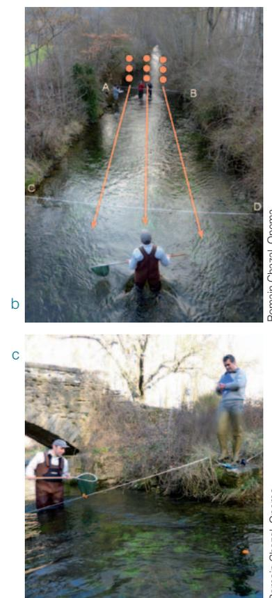
Fig. 6.1 - Mode opératoire du jaugeage par flotteurs (a, ci-contre). Exemple d'application avec clémentines sur le Durzon (b et c, ci-dessus).
